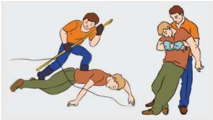
Сбросьте с пострадавшего провод сухим, не проводящим ток, предметом (палка, пластик).
